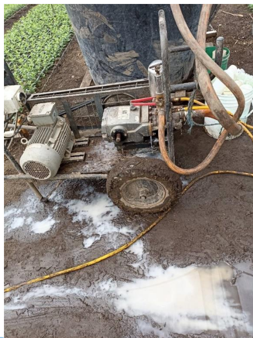
Figura 11. Derrame de producto proveniente de la bomba estacionaria en el camino central del bloque 5.
