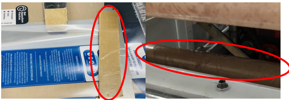
Figura 18. Izq. Desbloqueador de selladora con recubrimiento de teflón. Der. Rodillo de termoformadora con recubrimiento de teflón (Alico, 2023).
