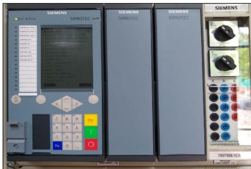
Figura 32. Relé contra sobrecorrientes. [15]
