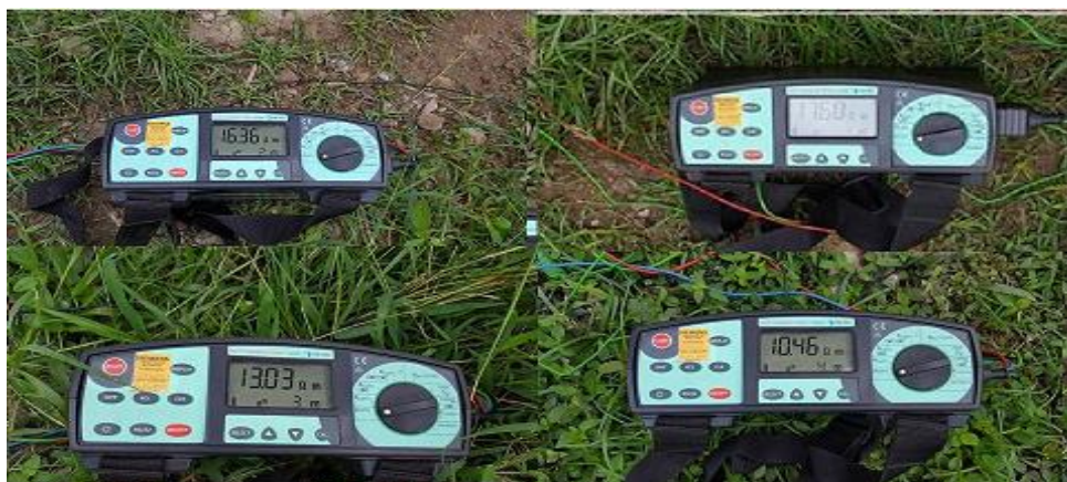
Figura 21. Resultados obtenidos de las medidas de resistividad con el Telurómetro Metrel
