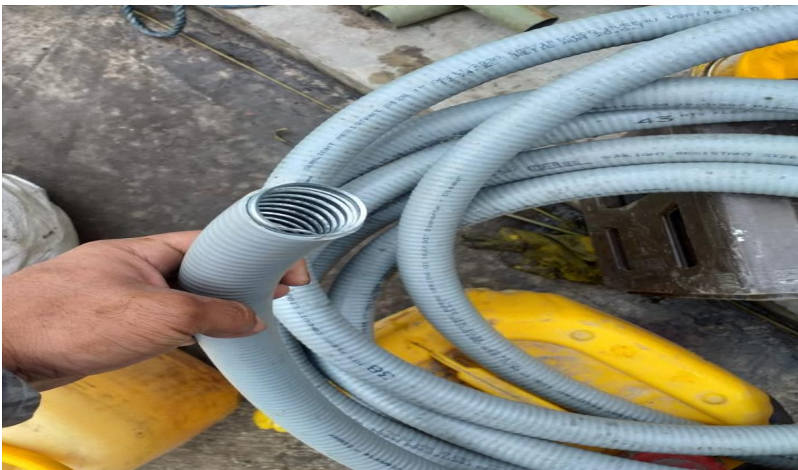
Imagen 37. Canalización coraza en material metal-plástico
