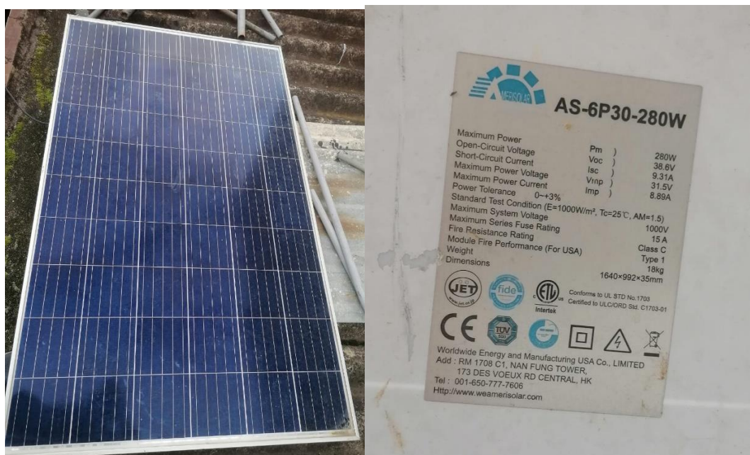
Ilustración 38. panel de pruebas y sus características de fabricación.
