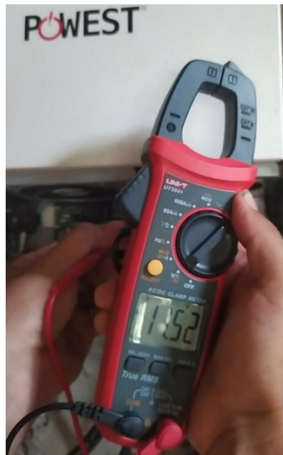
Figura 39. Voltaje en baterías del usuario U15
