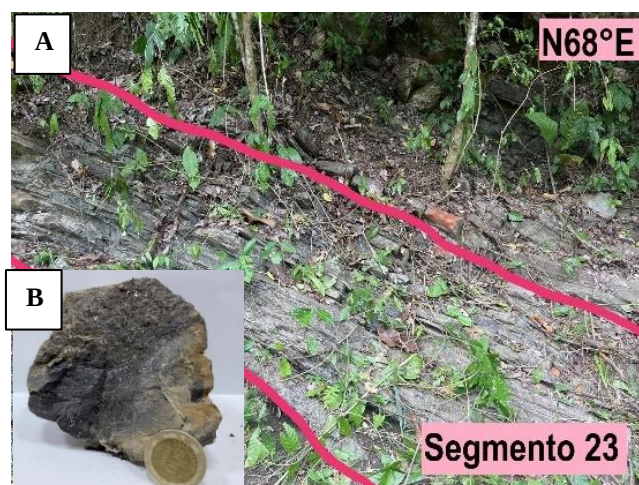
Ilustración 19. A) Facies de calizas biomicríticas, bioesparíticas, micríticas y chert tabulares. B) Biomicrita con estructura interna masiva con contenido de dolomita, extraída de la base del segmento 23. Fuente: Autores.
