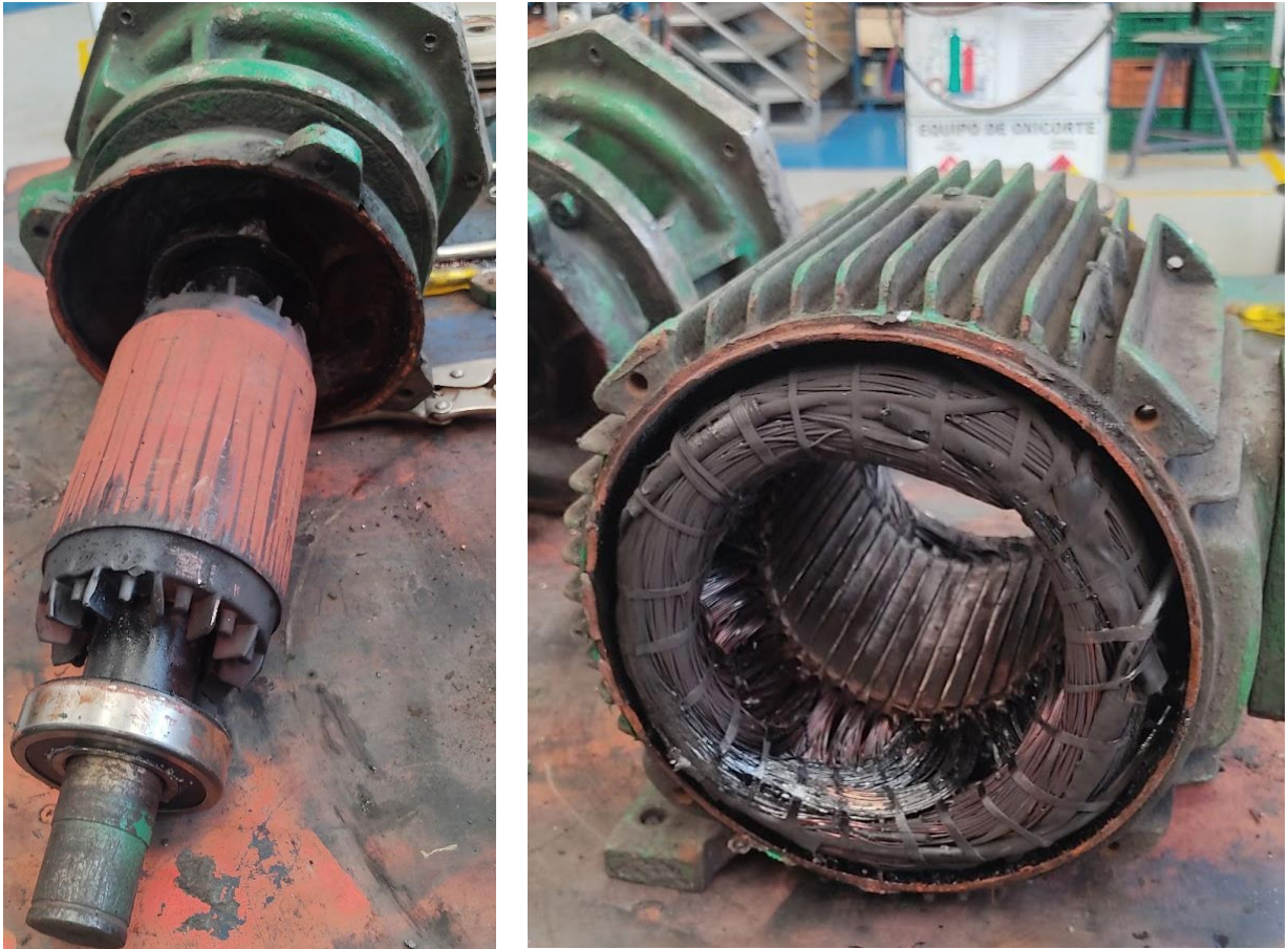
Figura 15.1 Motor eléctrico con bobinado en cortocircuito.
