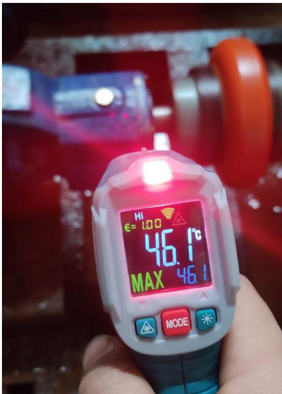
Figura 15.6 Medición de temperatura con termómetro infrarrojo
