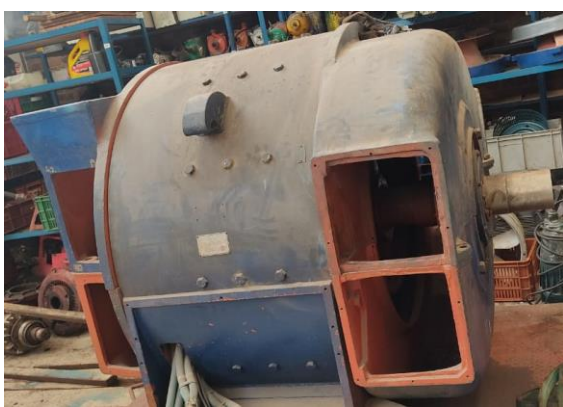
Figura 15.3 Motor de corriente directa 300 hp-230V.
