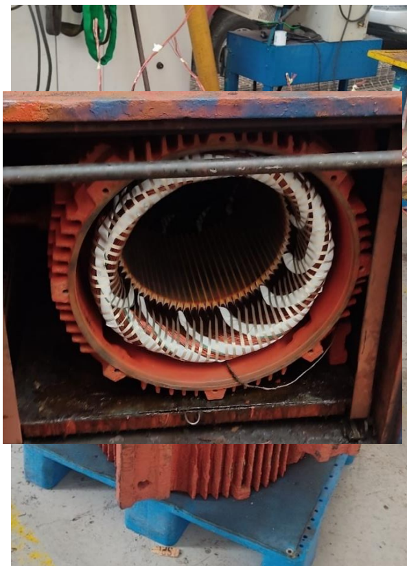
Figura 15.5 Motor de 100 Hp listo para realizar conexionado
