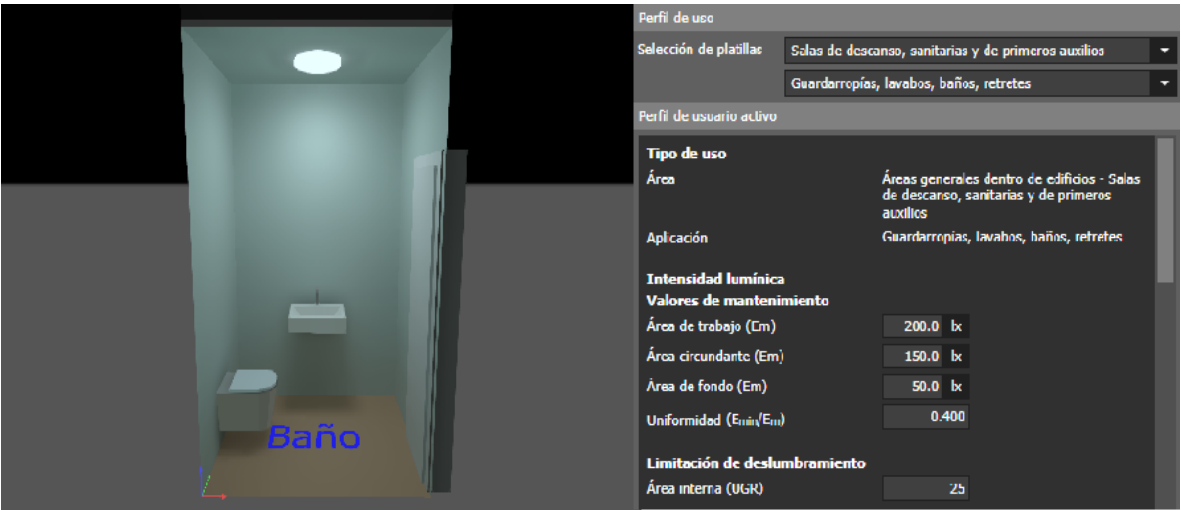
Ilustración 38. Iluminación, unidad sanitaria
