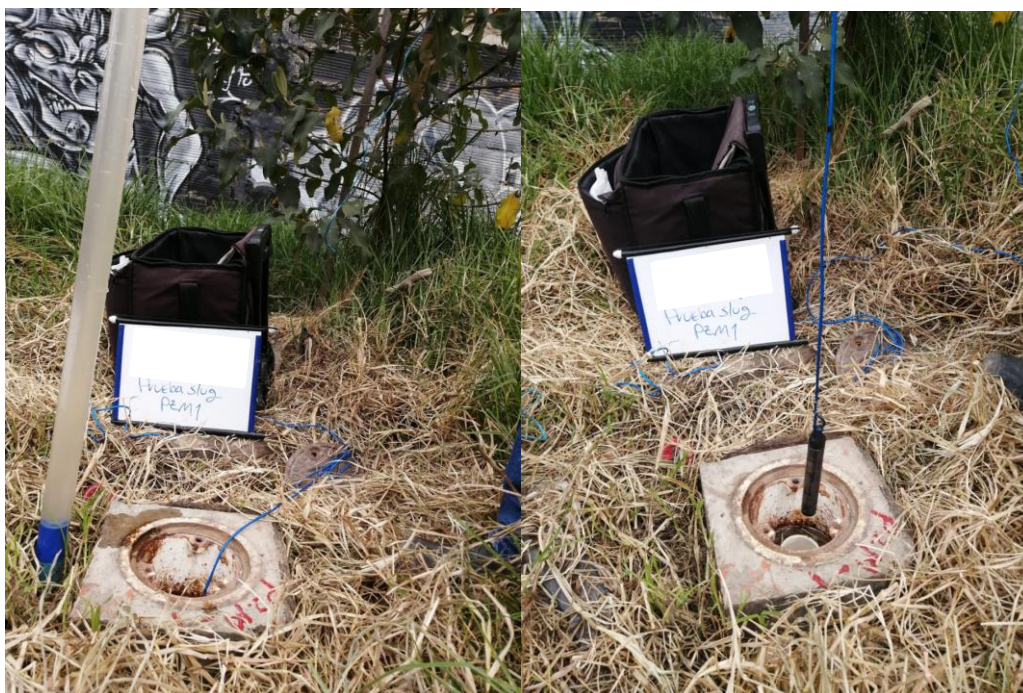
Figura 8. Realización de las pruebas Slug. Fuente: Autor
