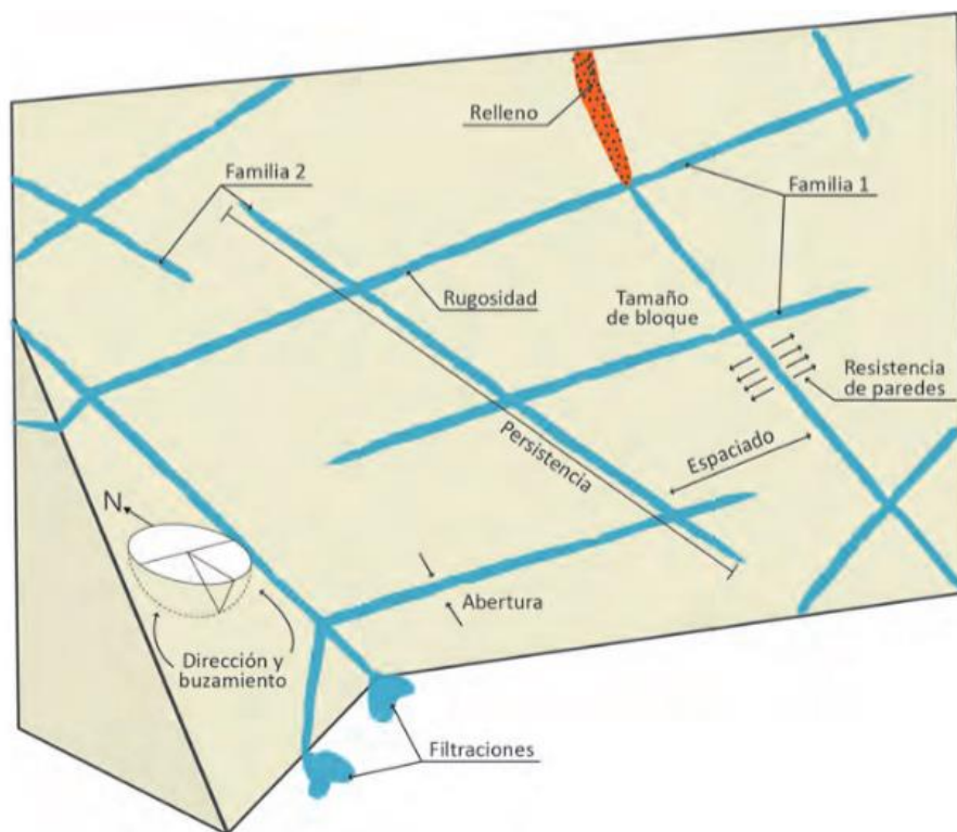
Figura 3. Representación esquemática de las propiedades de las discontinuidades
