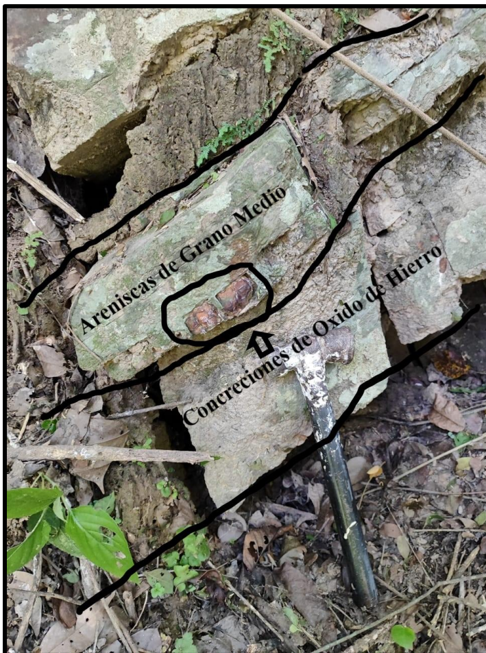
Ilustración 7. Intercalación de areniscas y arcillolitas con presencia de Concreciones de Hierro. Fuente: Autor
