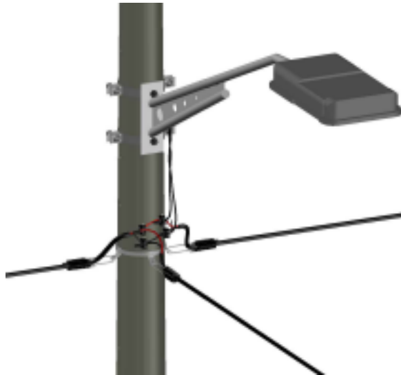
FIGURA 69 Detalle conexión alumbrado público[39].
