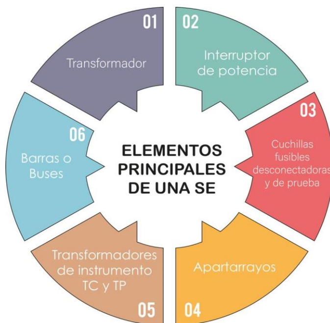
Ilustración 1 Elementos de una subestación eléctrica
