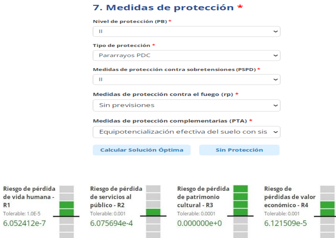
Figura 32. Tipo y nivel de protección de pararrayos tomada de:INGESCO Calculus
