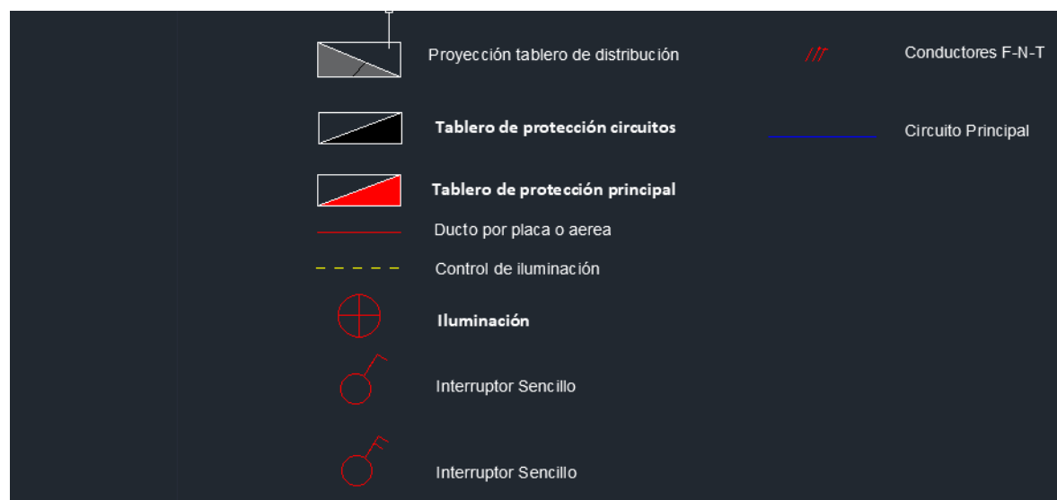
Ilustración 14. Simbología para sistema de iluminación
