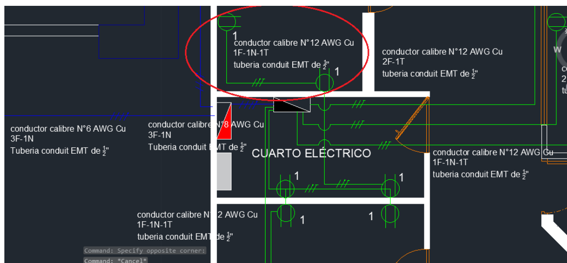
Ilustración 4. Especificaciones generales de conductores y tuberías
