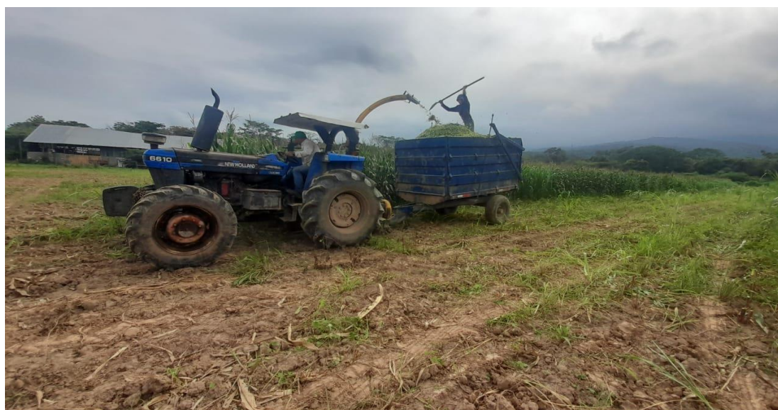
Ilustración 16. TRACTOR Y COSECHADORA EN PROCESO DE COSECHA Y PICADO DEL MAÍZ.
