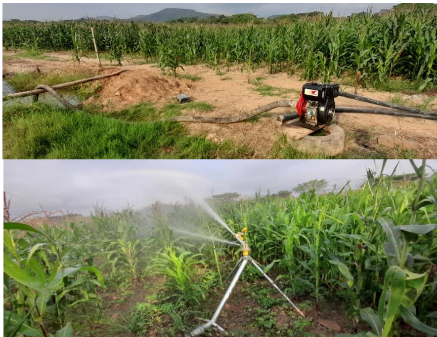
Ilustración 15. SISTEMA DE RIEGO POR ASPERSION CON CAÑON EN EL CULTIVO
