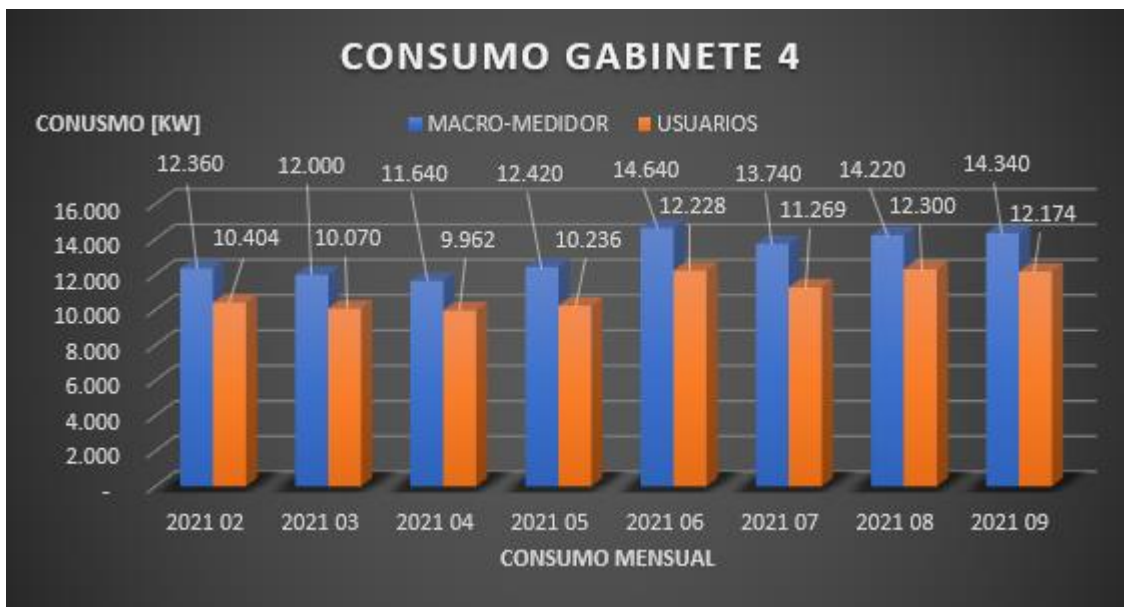
Ilustración 11. Entrada de Energía – Salida de Energía, Gabinete 4
