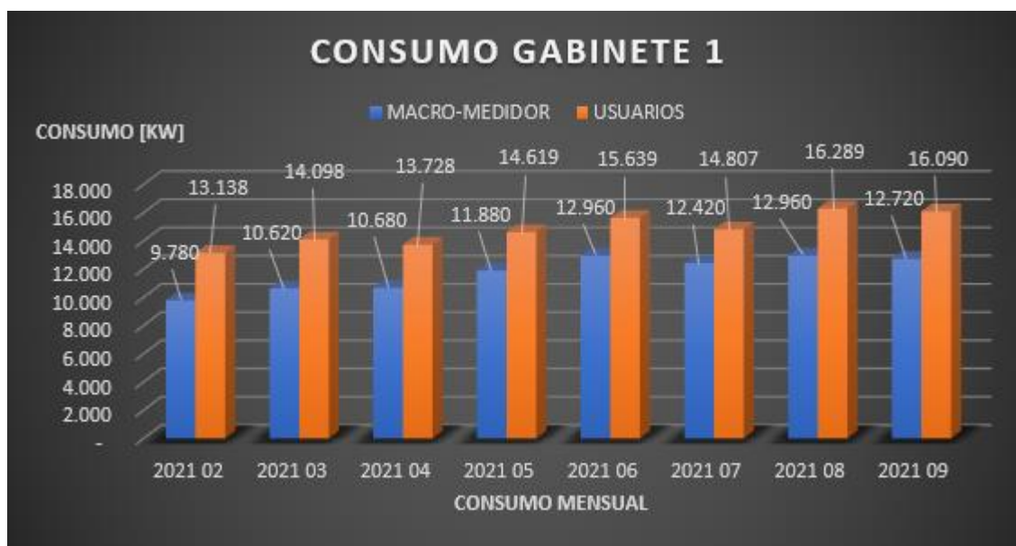
Ilustración 9. Entrada de Energía – Salida de Energía, Gabinete 1
