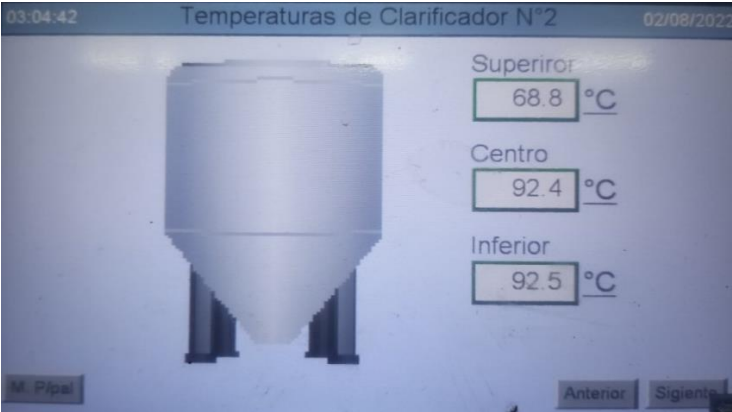
Figura 12. Variables monitoreadas en el proceso de clarificación. Registro fotográfico.
