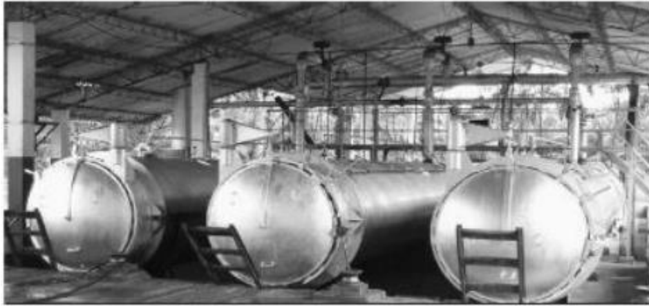
Figura 6. Esterilizadores de planta extractora de palma. Tomado de Rincón (2010).
