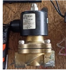
Fig. 24. Válvula Solenoide metálica. Fuente: Autor.
