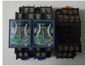
Fig. 29. Relés con base. Fuente: Autor.
