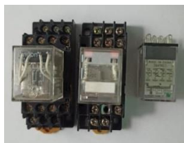
Fig. 19. Relés con base. Fuente: Autor.
