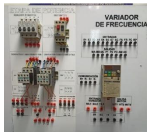
Fig. 10. Banco de pruebas para el control de una banda transportadora. Fuente: Autor
