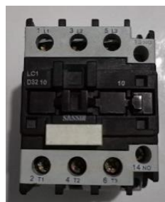
Fig. 16. Contactor. Fuente: Autor.
