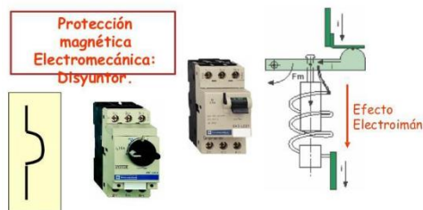
Fig.1. Protección magnética electromecánica Fuente: [24].
