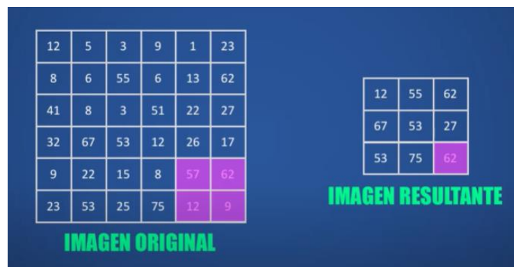
Figura 17. Proceso de max-pooling en una matriz de imagen. Fuente (Usca, 2018)
