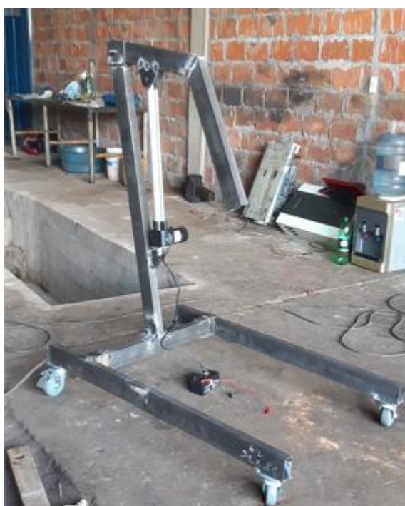
Figura 30. Prueba de funcionamiento con actuador lineal. (Autor)
