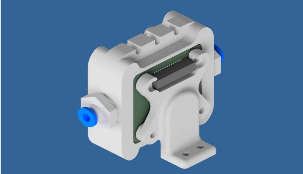
Figura 49 Modelo 3D de la cámara de sensores MEMS MOS
