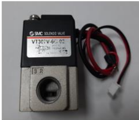
Figura 42 Electroválvula de accionamiento directo 3 vías 2 posiciones
