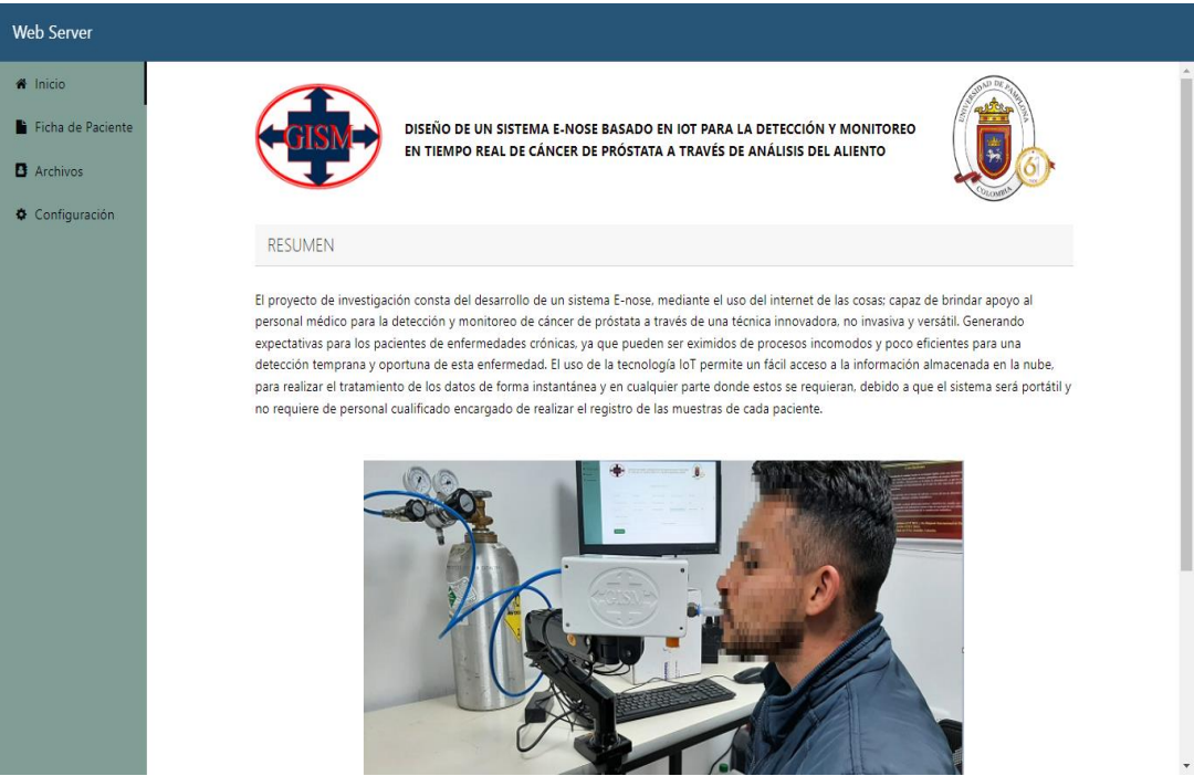
Figura 61 Página de inicio del servidor web IoT diseñado
