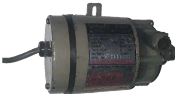
Figura 26. Bomba de agua magnética implementada. Fuente: Autor
