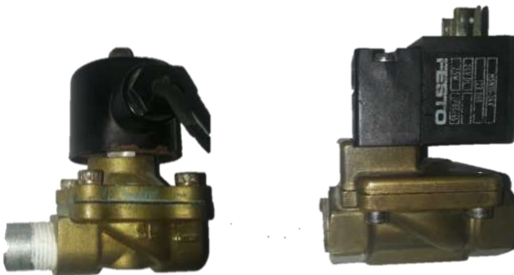
Figura 24. Electroválvulas implementadas. Fuente: Autor
