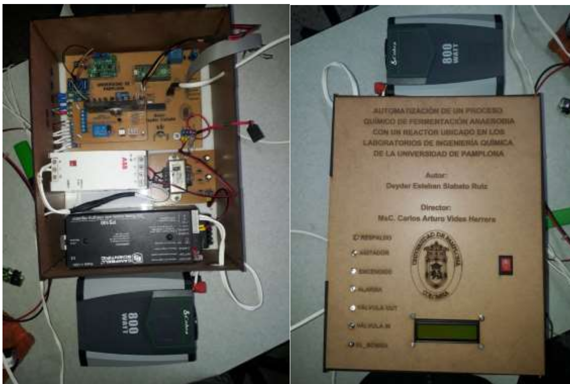
Figura 49. Resultado final sistema de automatización. Fuente: Autor
