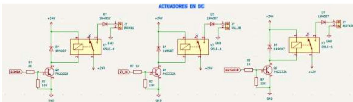
Figura 40. Conexión actuadores en DC. Fuente: Autor
