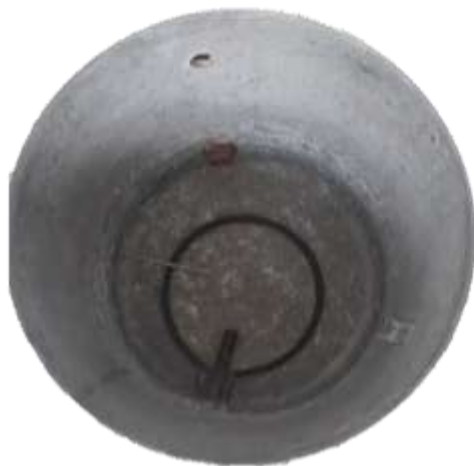
Figura 23. Resistencia calefactora implementada. Fuente: Autor
