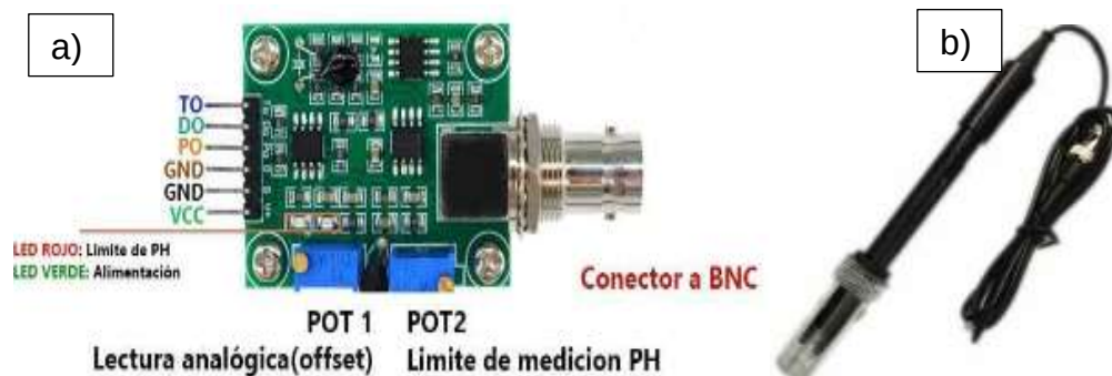
Figura 20. (a) Modulo acondicionador de la señal (b) Electrodo de pH. Fuente: e.-. G. M. Central
