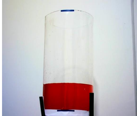
Figura. 33 Tanque prototipo con marcadores para detección del porcentaje de nivel [autor].
