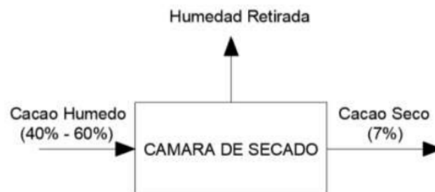
Figura 9. Diagrama representativo del objetivo del sistema extracción de humedad Fuente: (Alexis Fabian Barbecho, 2019)
