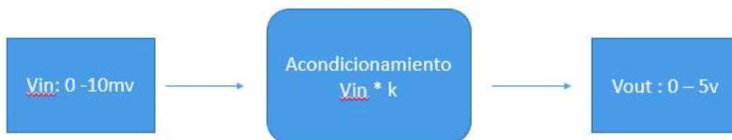
Figura 18. Representación en diagrama de bloques del diseño de acondicionamiento del LM35
