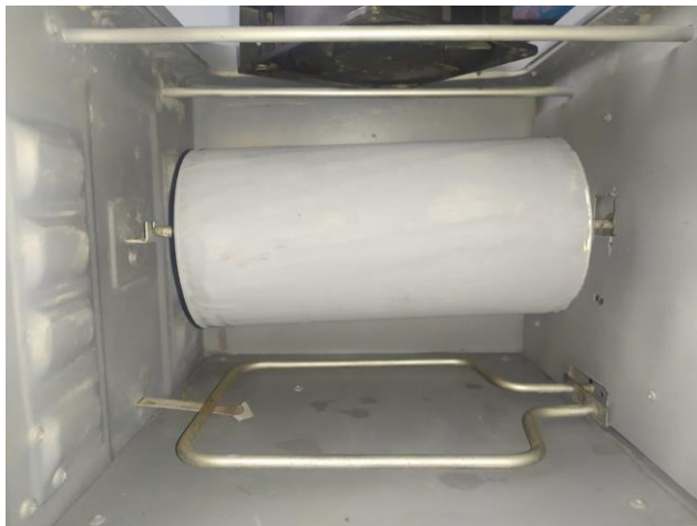
Figura 65. Instalación del sistema de rotación – tanque contenedor del grano Fuente: El Autor
