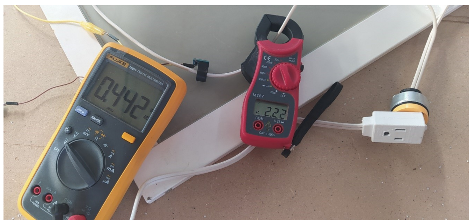
Figura 38: Imagen prueba sensor de corriente, con corriente de entra 2,22A(Autor).
