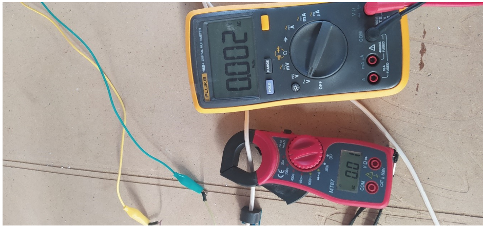
Figura 40: Imagen prueba sensor de corriente, con corriente de entra 0.01A(Autor).
