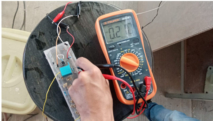
Figura 42: Imagen prueba sensor de voltaje, con voltaje de entrada 210V (Autor).
