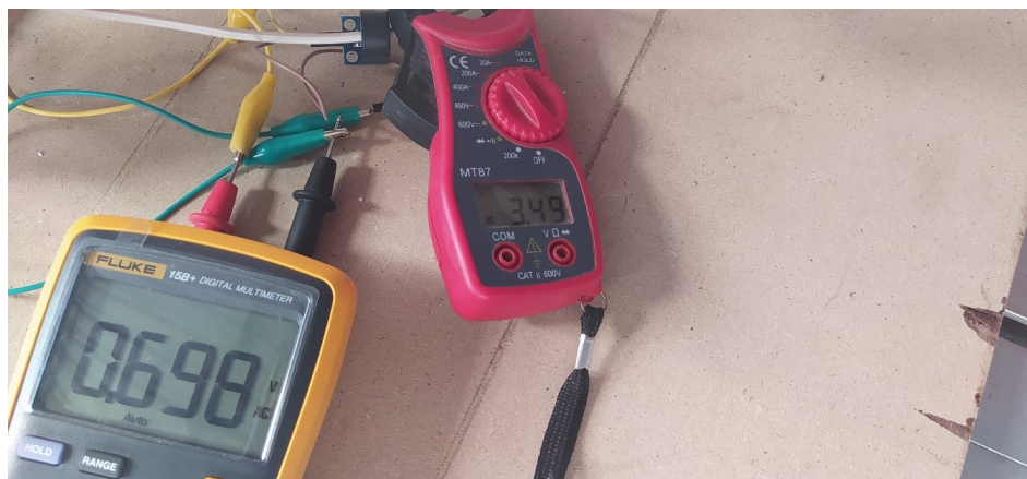
Figura 37: Imagen prueba sensor de corriente, con corriente de entra 3,49A (Autor).
