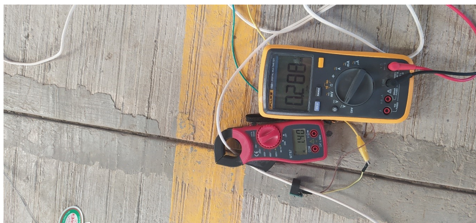
Figura 39: Imagen prueba sensor de corriente, con corriente de entra 1,40A(Autor).
