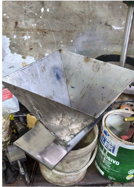
Figura 34. Tolva terminada. [Autor].
