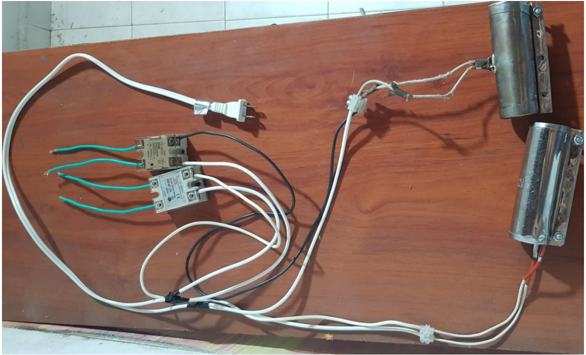
Figura 59. Conexiones de las resistencias tipo abrazadera con relé de estado sólido "SSR". [Autor].
