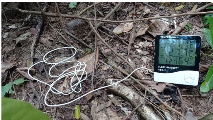
Figura 5. Termohigrómetro digital con sonda (HTC-2) para el registro de temperatura y humedad relativa.
