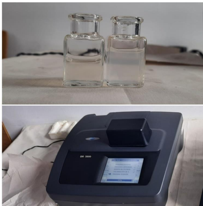
Figura 12. Prueba de sulfato. A) 1 celda control, 2 celda muestra de agua. B) Espectrofotómetro.
