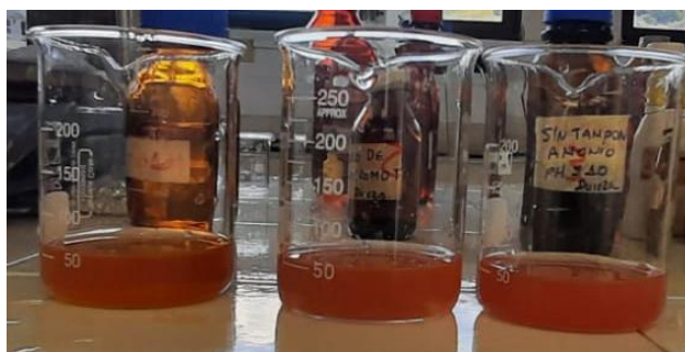
Figura 10. Prueba de cloruros. (Fuente: autor)
