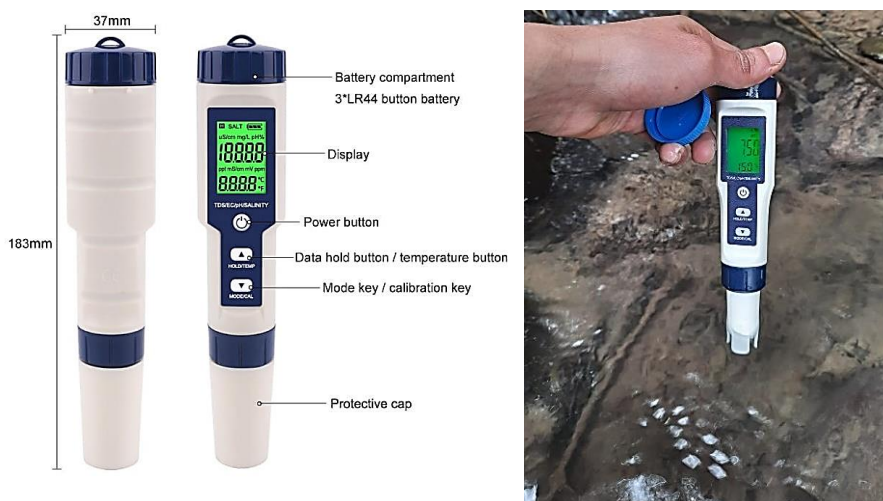
Figura 7. Multiparámetro 5 en 1 modelo 9909-SP (A) partes (B) aplicación en campo.
