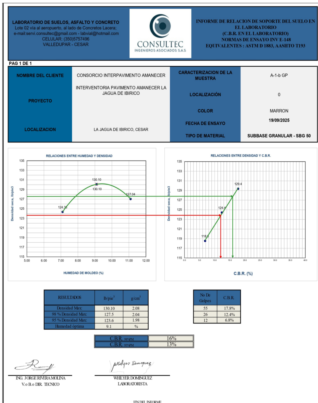
Figura 44. Ficha técnica de la sub-base granular
