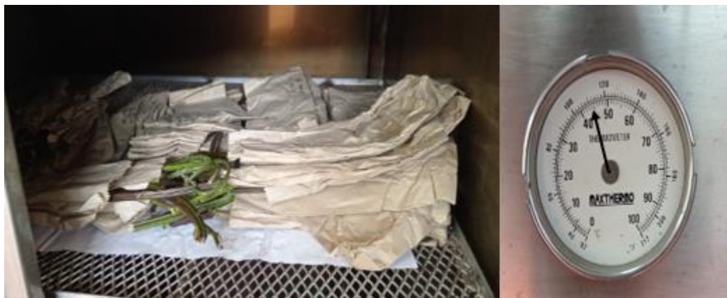
Anexo 20. Muestras recolectadas en horno a 45° constantes durante 3 días para la obtención de peso seco de hojas, tallo y raíz.
