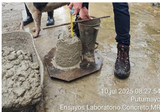
Figura 6. Ensayo de asentamiento o Slump.
