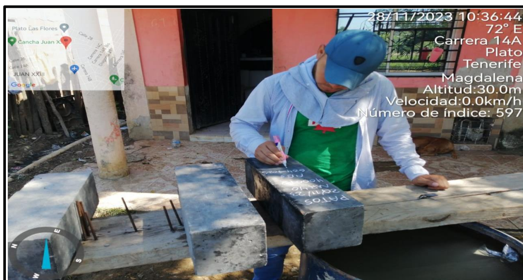
Ilustración 52. Marcado de viguetas para ensayo de flexión.
