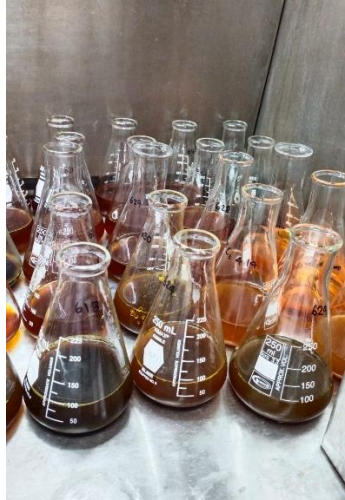
Figura 11. Adición de agua a las muestras con solución extractora (Fuente propia).
