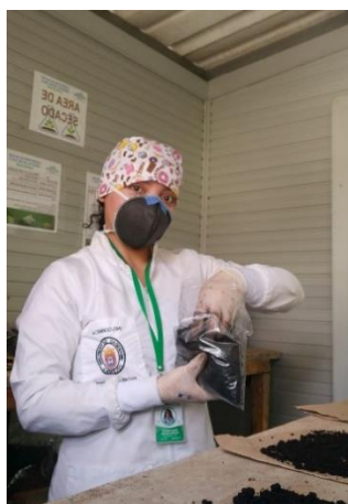
Figura 7. Disposición de muestras en papel kraf para el secado (Fuente propia).
