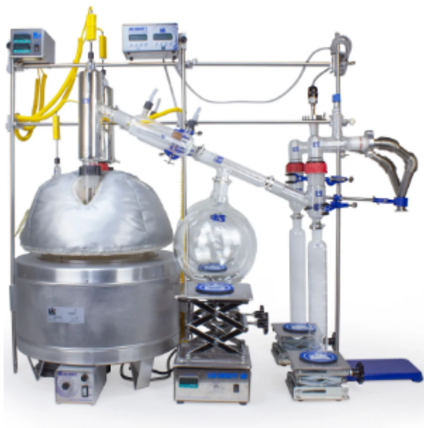
Figura 4.6: Destilación de camino corto
