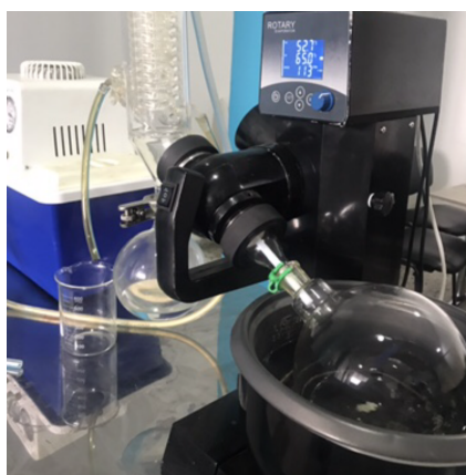
Figura 5.3: Montaje para la recuperación de solvente
