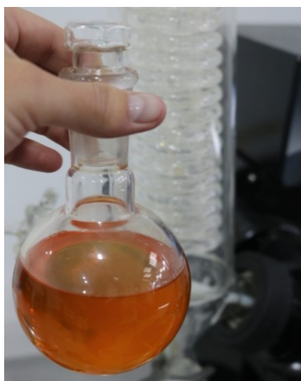
Figura 5.6: Destilado por vía corta
