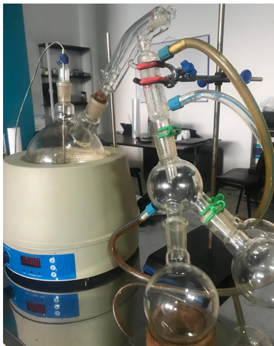
Figura 5.5: Montaje para la destilación de vía corta
