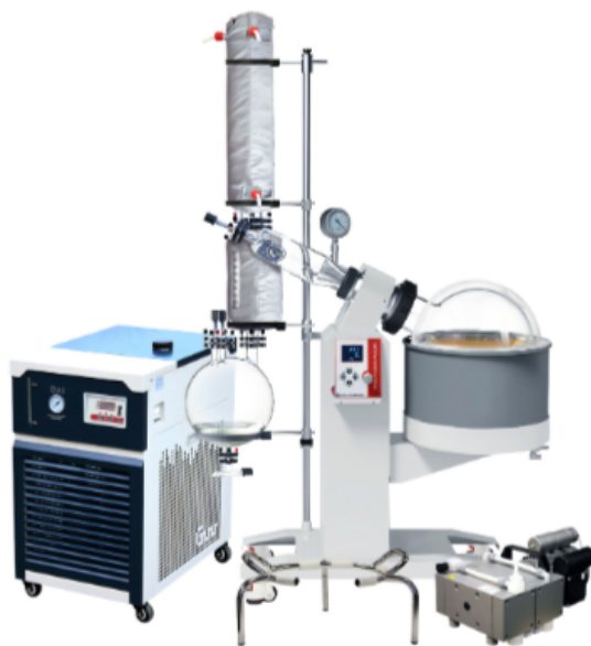
Figura 4.5: Evaporador giratorio para la recuperación de solvente
