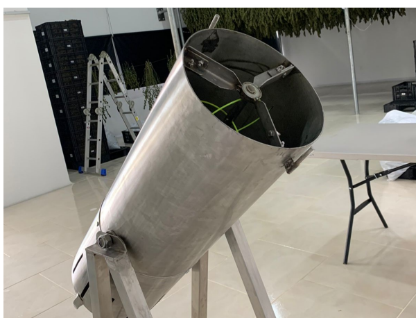
Figura 4.3: Trituradora para material vegetal
