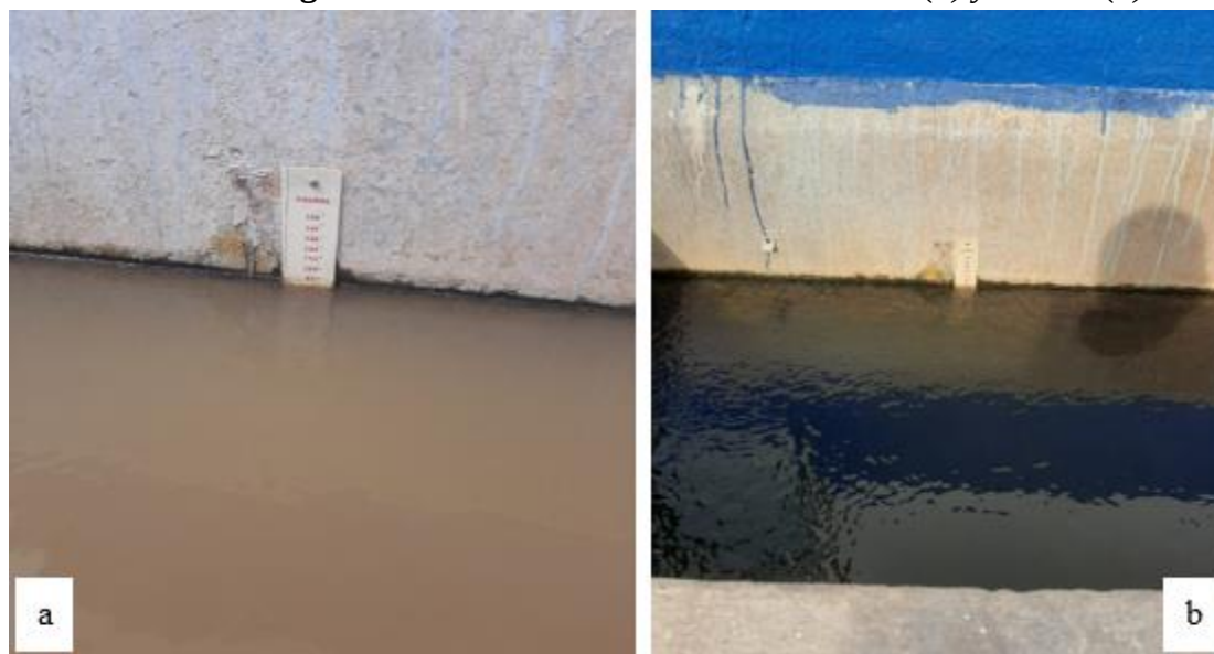
Figura 15. Medidor de caudal en invierno (a) y verano (b)
