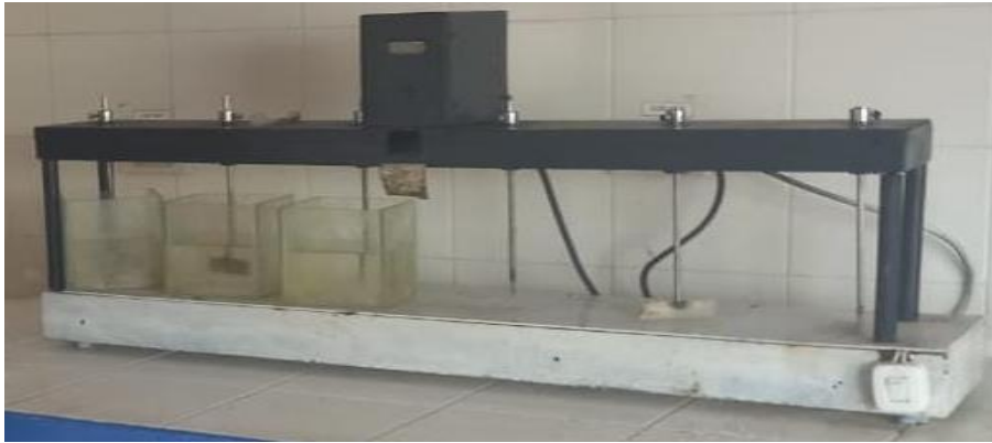
Figura 3. Aparato de prueba de jarras.
