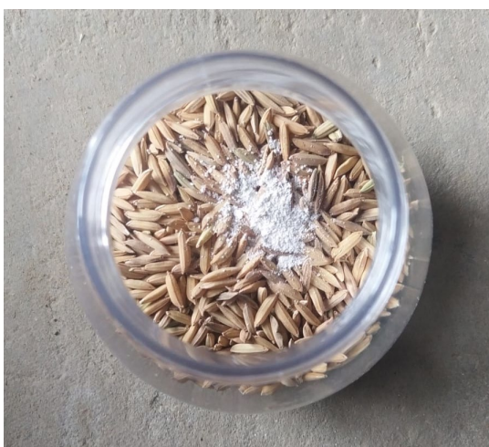
Figura 23. Formulación F1.2 que contenía (75% SiO 2 - 25% NaHCO 3 ) (Fuente: propia)
