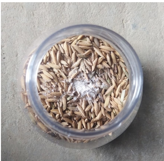
Figura 22. Formulación F1.1 que contenía (75% SiO 2 - 25% NaHCO 3 ) (Fuente: propia)
