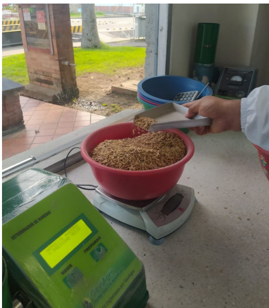
Figura 38. Pasando la muestra F3,0 por el Motonco para determinar el nivel de humedad.
