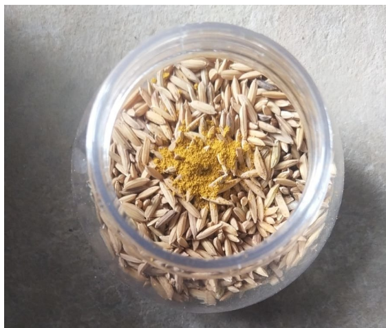
Figura 26. Formulación F3.1 que contenía (75% \text{Fe}_2\text{O}_3 -25% \text{NaHCO}_3 ) (Fuente: propia)
