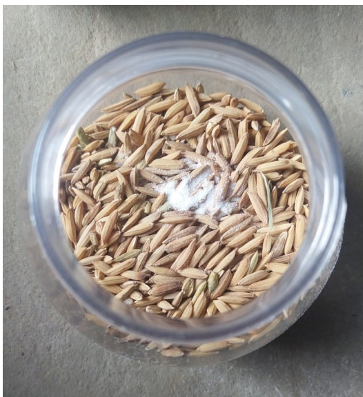
Figura 24. Formulación F2.1 que contenía (75% \text{Al}_2\text{O}_3 -25% \text{NaHCO}_3 ) (Fuente: propia)
