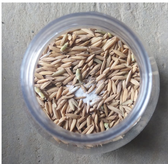
Figura 25. Formulación F2.2 que contenía (75% \text{Al}_2\text{O}_3 -25% \text{NaHCO}_3 ) (Fuente: propia)
