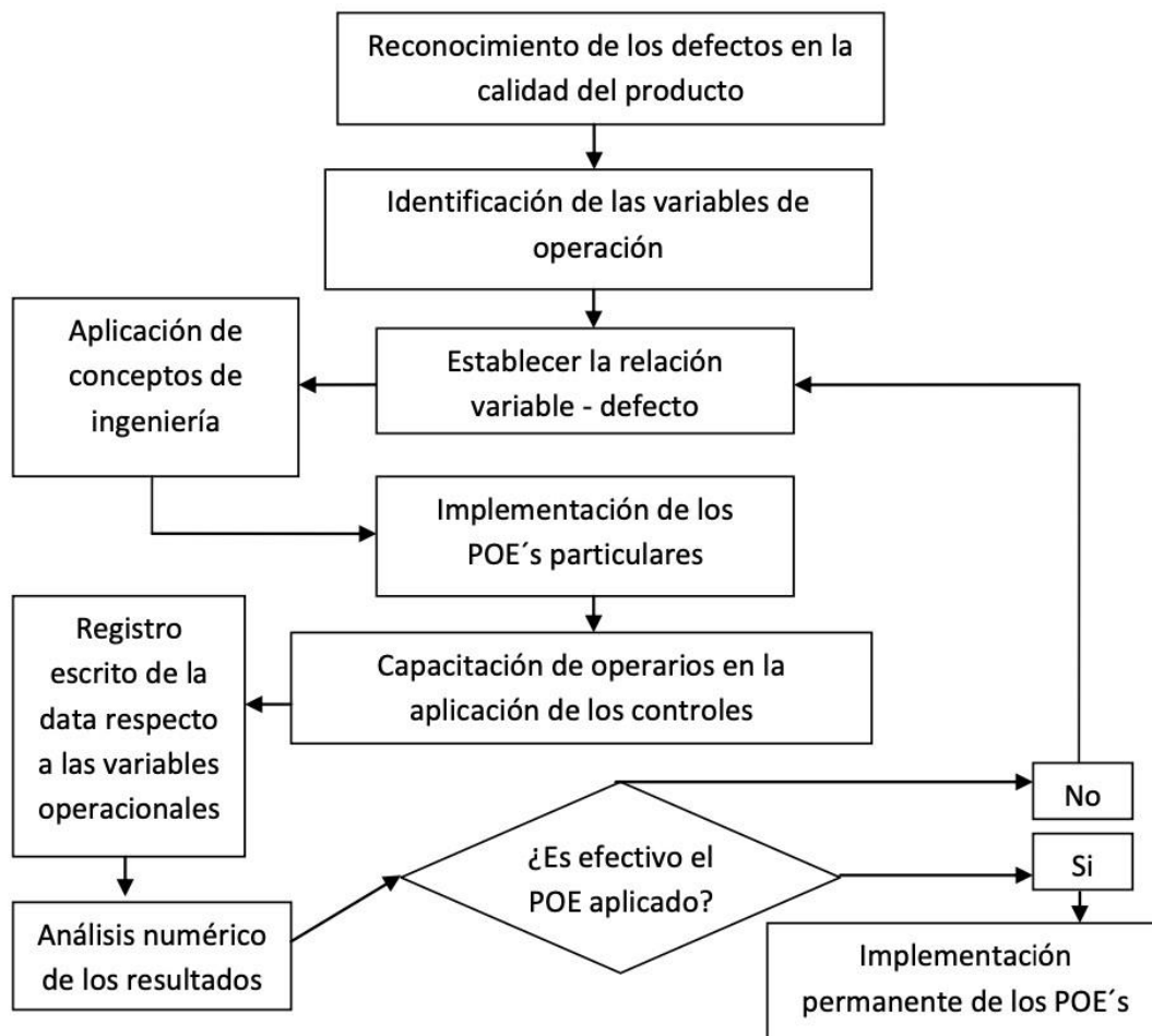
Figura 16. Algoritmo de proceso para los Procedimientos Operacionales Estándar (POE).
