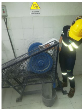
Figura 10. muestra procesada en la trituradora de mandíbulas.
