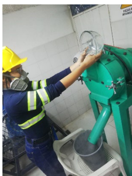
Figura 12. Muestra procesada en la pulverizadora de discos.
