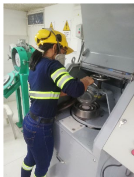
Figura 14. Muestra procesada en la pulverizadora de anillos.
