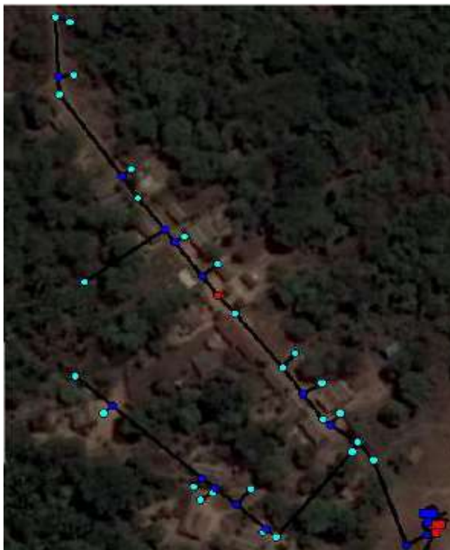
Figura 15. Esquema de la red dibujada en EPANET
