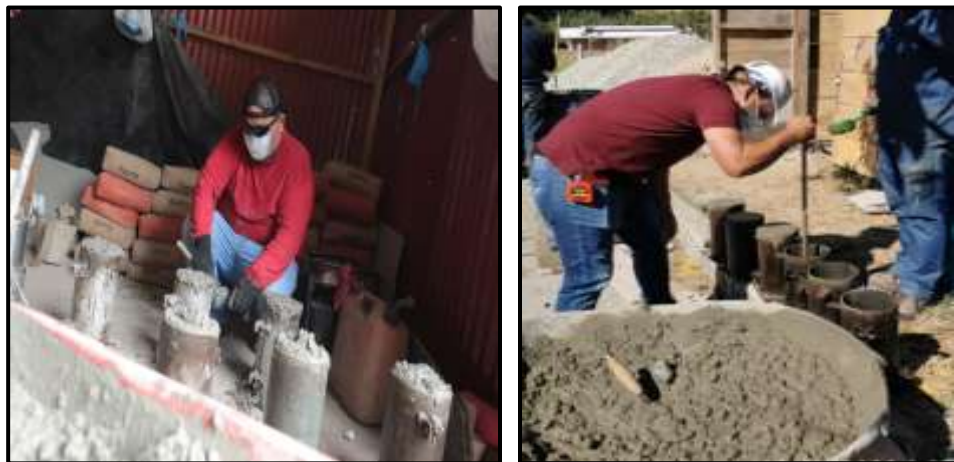
Figura 38. Elaboración cilindro de concreto.
