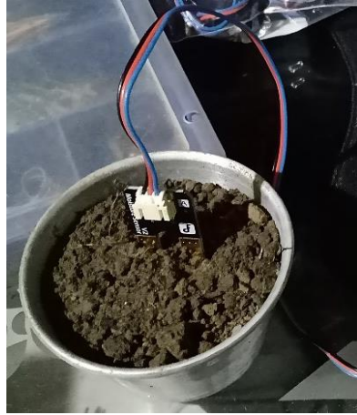
figura 30 Pruebas de verificación de funcionamiento del sensor de humedad
