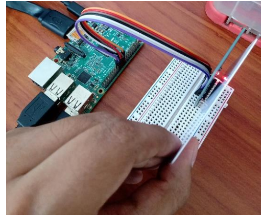
figura 42 Pruebas de funcionamiento del lector RFID con las tarjetas RFID
