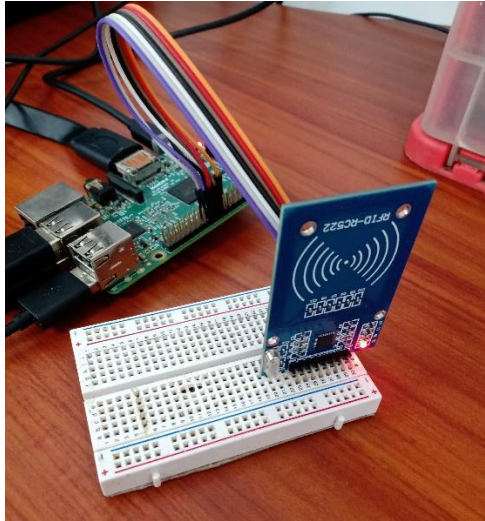
figura 41 Conexión del lector RFID para ser sometido a pruebas de funcionamiento
