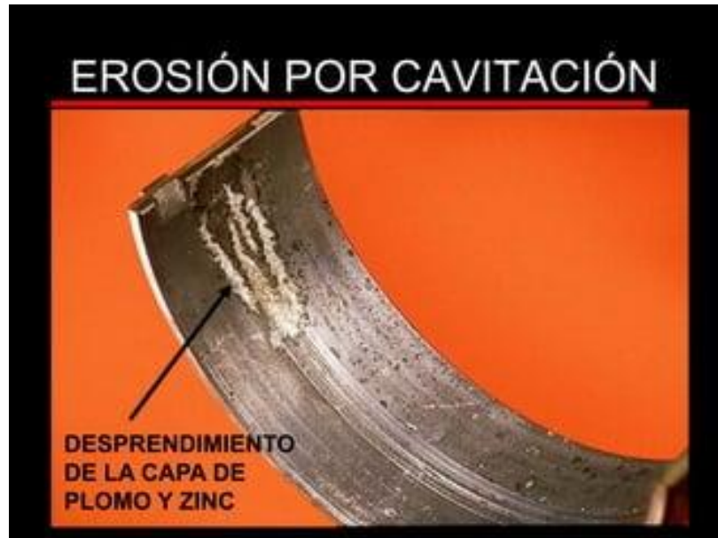
Figura 29. Desgaste por cavitación
