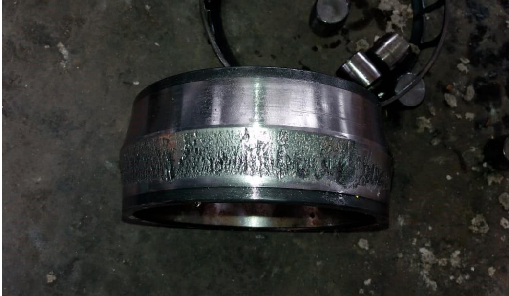
Figura 28. Desgaste por fatiga superficial
