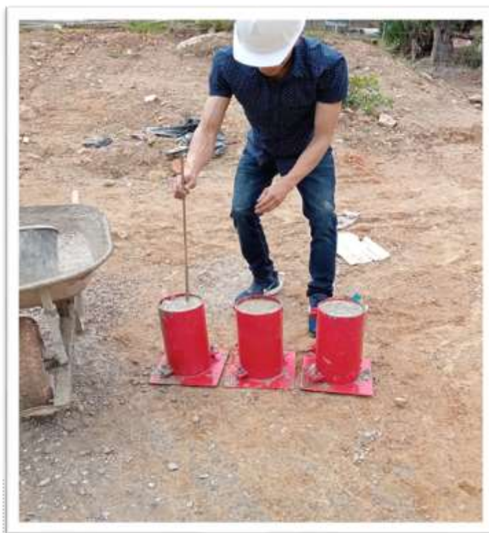
Ilustración 17 recolección de probetas de concreto para análisis de resistencia
