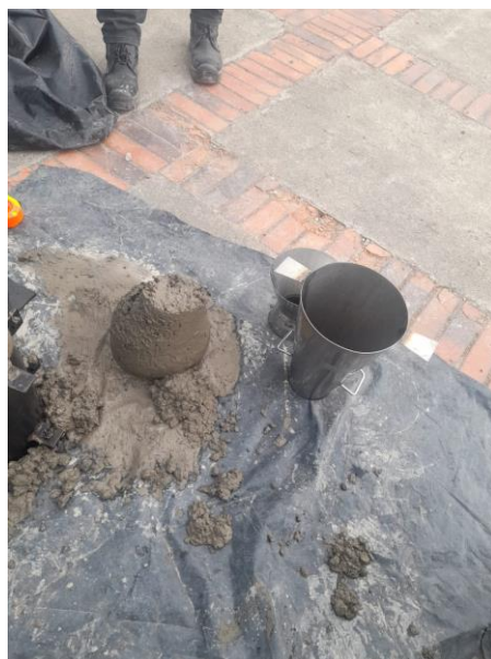
Ilustración 24: Asentamiento Fuente propia
