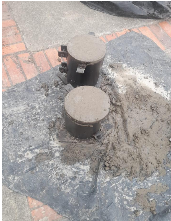
Ilustración 25: Cilindros de concreto Fuente Propia
