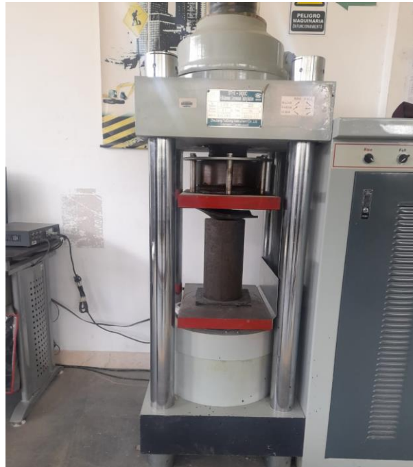
Ilustración 27: Prueba de resistencia del concreto Fuente propia
