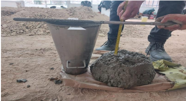
Figura 13. Ensayo de asentamiento o slump
