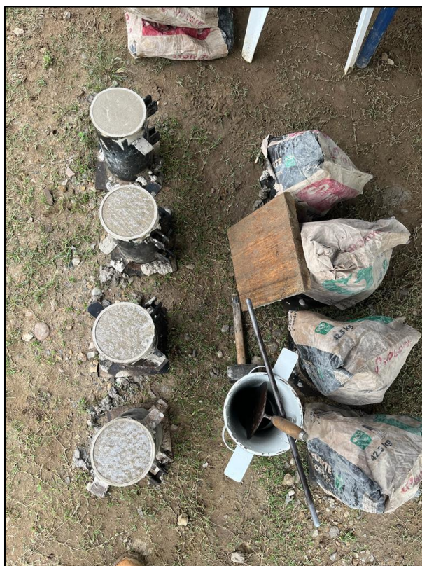
Ilustración 31. Muestra para ensayo de resistencia
