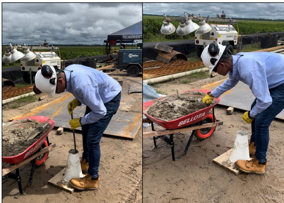
Ilustración 30. Toma de asentamiento del concreto con el cono de Abrams
