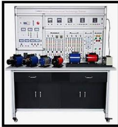
Figura 4 Modulo de banco de motores CHOIEO sin medidores de variables
