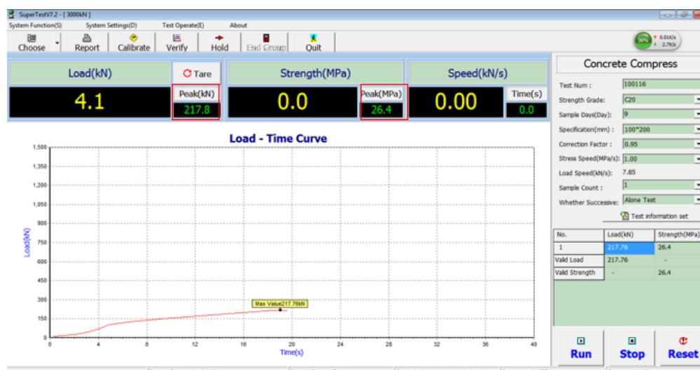
Figura 47. Resultados obtenidos ensayo de compresión a los 14 días Muros pantalla
