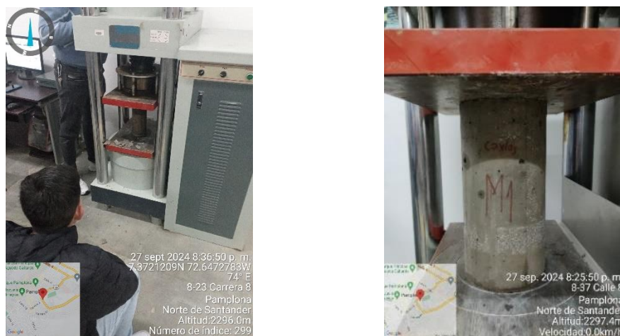
Figura 40. Ensayo de resistencia a la compresión
