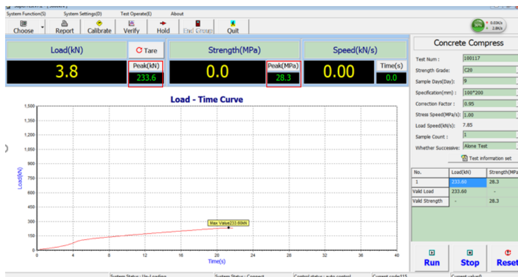
Figura 55. Resultados obtenidos ensayo de compresión a los 14 días elementos fundidos con concreto hecho en obra
